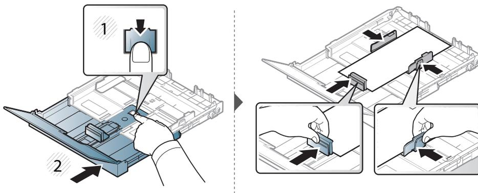
Para papéis maiores do que o tamanho ofício, pressione e solte a guia da trava na bandeja e puxe-a manualmente. Em seguida, ajuste as guias de comprimento e largura do papel.
