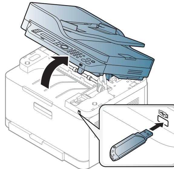
A porta USB existente na parte frontal do equipamento foi desenvolvida para dispositivos de memória USB 1.1 e 2.0. O seu equipamento oferece suporte a dispositivos de memória USB com FAT16/FAT32 e tamanho de setor de 512 bytes.
