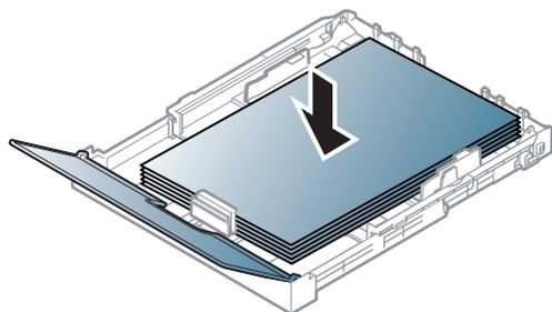
Para papéis de tamanhos menores do que os papéis de Carta, pressione e solte a guia da trava na bandeja e empurre-a manualmente. Em seguida, ajuste as guias de comprimento e largura do papel.
